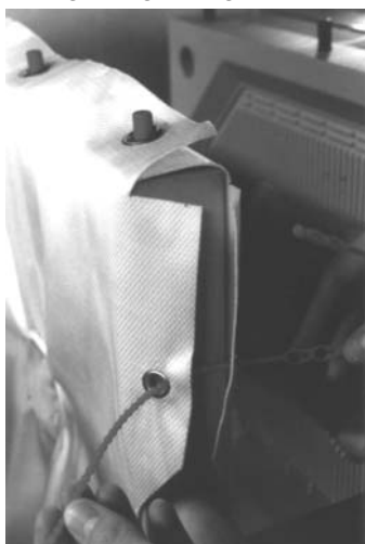
COLOCAR LOS ORIFICIOS EN LOS PIUS SUPERIORES Y COLOCAR LAS ABRAZADERAS DE PLASTICO
